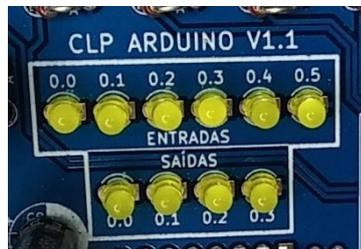
A placa possui 10 leds. Os 6 superiores são indicadores das entradas (I0.0 a I0.5) e os 4 inferiores são indicadores das saídas (O0.0 a O0.3).
