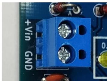
Borne onde devem ser conectados os cabos de alimentação da placa CLP Arduino 1.1.
